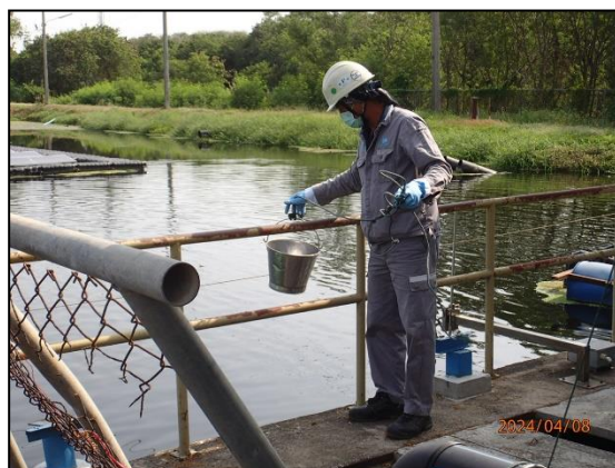
รูปที่ 4.31 การเก็บตัวอย่างน้ำทิ้งหลังผ่านระบบบำบัดน้ำเสียส่วนกลางทางชีวภาพ
