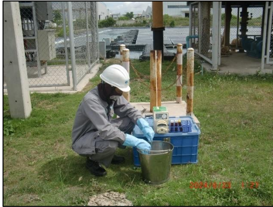
รูปที่ 4.41 การเก็บตัวอย่างน้ำใต้ดิน บริเวณก่อนไหลผ่าน Holding Pond 2
