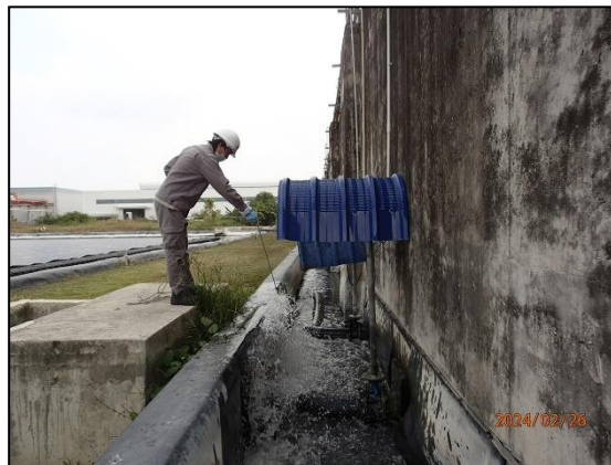
รูปที่ 4.30 การเก็บตัวอย่างน้ำทิ้งจากระบบบำบัดน้ำเสียแห่งที่ 4 (Sequencing Batch Reactor)
