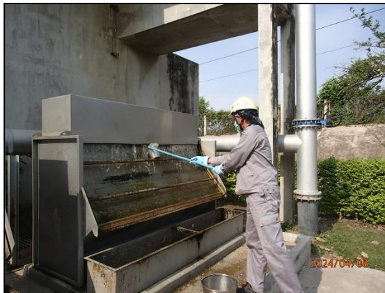
รูปที่ 4.26 การเก็บตัวอย่างน้ำทิ้งจากระบบบำบัดน้ำเสียแห่งที่ 1 (Activated Sludge) บริเวณ บ่อ Equalization Tank
