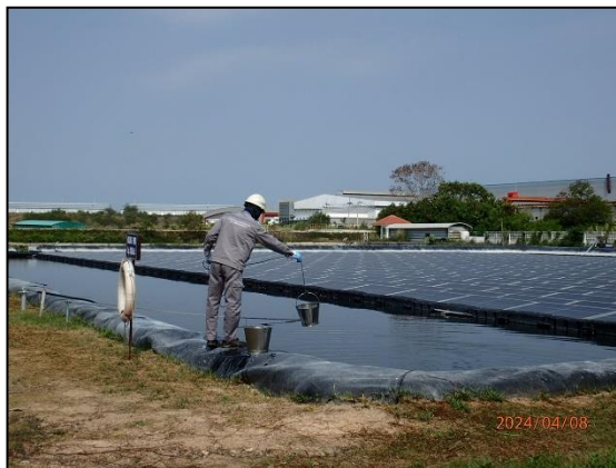
รูปที่ 4.32 การเก็บตัวอย่างน้ำทิ้งหลังผ่านระบบบำบัดน้ำเสียส่วนกลางทางชีวภาพ บริเวณ บ่อ Holding Pond แห่งที่ 2
