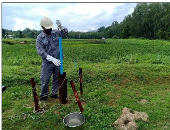
รูปที่ 4.12 การเก็บตัวอย่างน้ำใต้ดิน บริเวณ ก่อนไหลผ่าน Holding Pond 1
